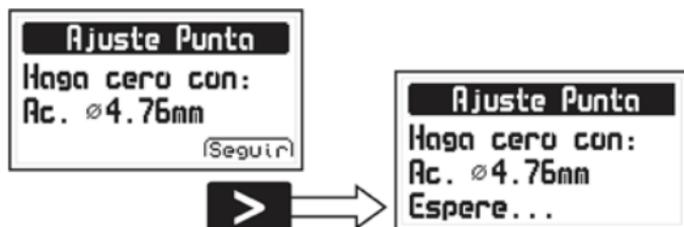
**Figura 2.15 Segundo paso del proceso de ajuste de punta**
