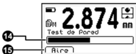
Figura 2.4: Pantalla de medición con test de pared
